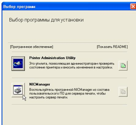
**9** Будет обнаружен принтер или принтеры, подключенные к локальной сети. Нажмите на принтер для конфигурирования (устройство). Выберите "AR-XXXX".**Примечание**
