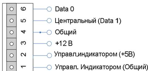
Рис. 17. Схема подключения при использовании считывателей типа «Wiegand-26»
