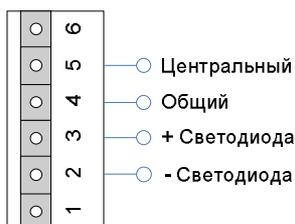
Рис. 18. Схема подключения при использовании считывателей типа «Wiegand-26»
