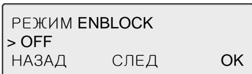
Нажимайте [СЛЕД] или
