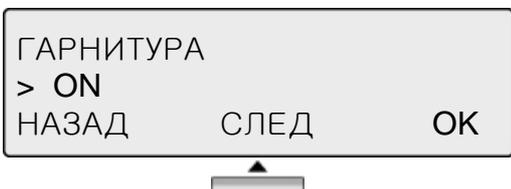
Нажимайте [СЛЕД] или
