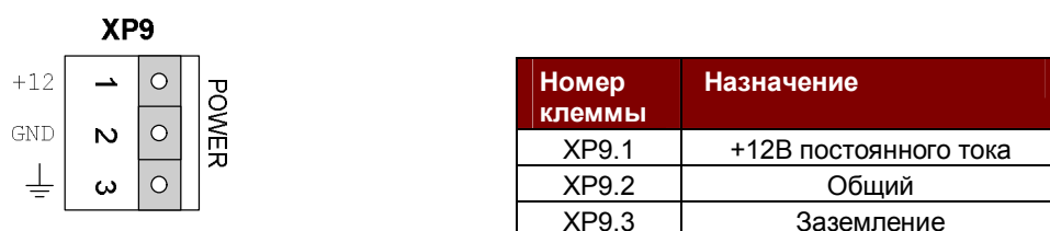
Рис. 23. Разъем XP9 (POWER)
