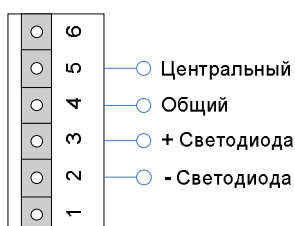
Рис. 18. Схема подключения при использовании считывателей типа «Wiegand-26»
